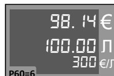
Для калибровки измерителя используется показанная на дисплее величина объема без температурной корректировки. Механическая или электронная калибровка измерителя проводится таким же образом, как и в предыдущем пункте.
