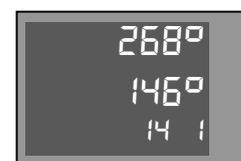
изображается температура топливного продукта 1 в гидравлической системе колонки в десятых долях градуса Цельсия (14.6°C).
