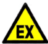
Pericolo di esplosione
