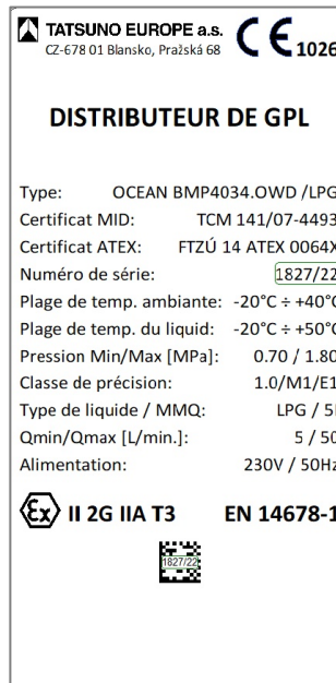
Image 12 - Plaque signalétique du distributeur de GPL à quatre tuyaux
