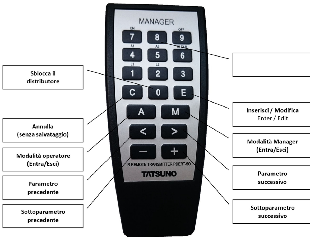
Figura 1 - Descrizione dei tasti del telecomando PDERT-50
