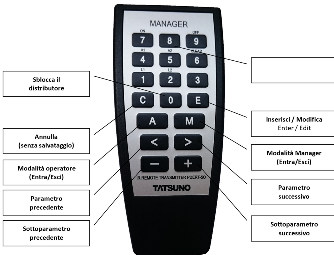
Figura 1 - Descrizione dei tasti del telecomando PDERT-50
