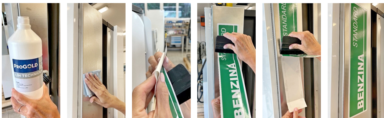
Image 78 - – Procédure de collage de l'autocollant du produit
