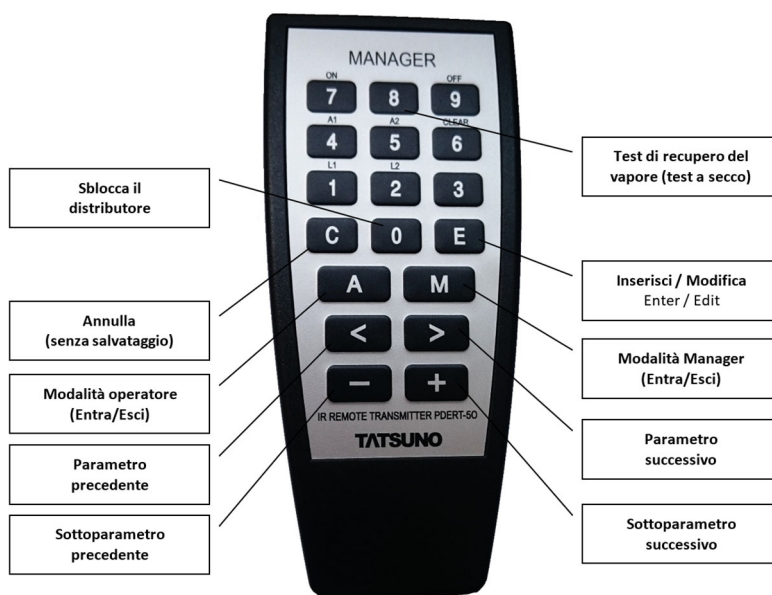
Figura 83 – Descrizione dei tasti del telecomando PDERT-50
