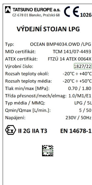
Obrázek 12 - Typový štítek čtyřhadicového LPG stojanu
