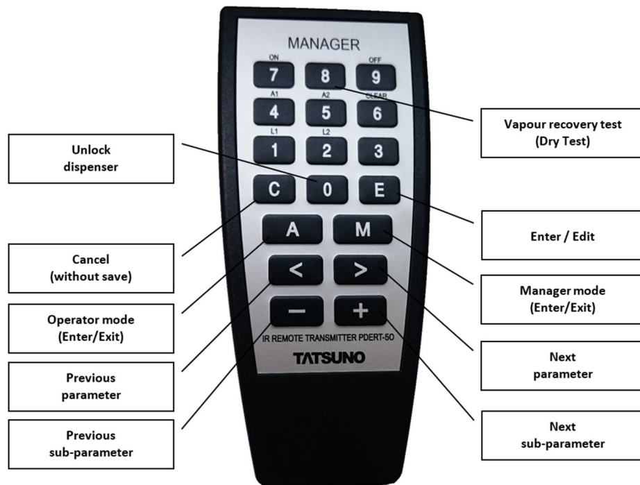
Figura 33 – Descrizione dei tasti del telecomando PDERT-50
