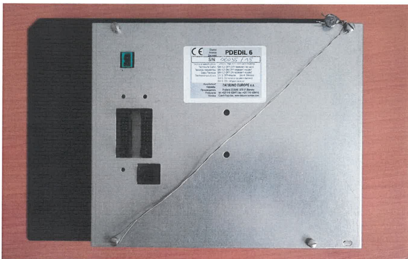
Abbildung Nr. 10b: Versiegelung des Summenzähler-Anzeigergerätes mit Display PDEDIL V6
